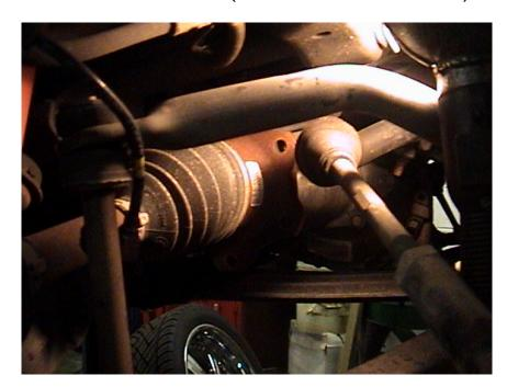
4. DISCONNECT UPPER BALL JOINT, LOWER BALL JOINT & TIE ROD END.
